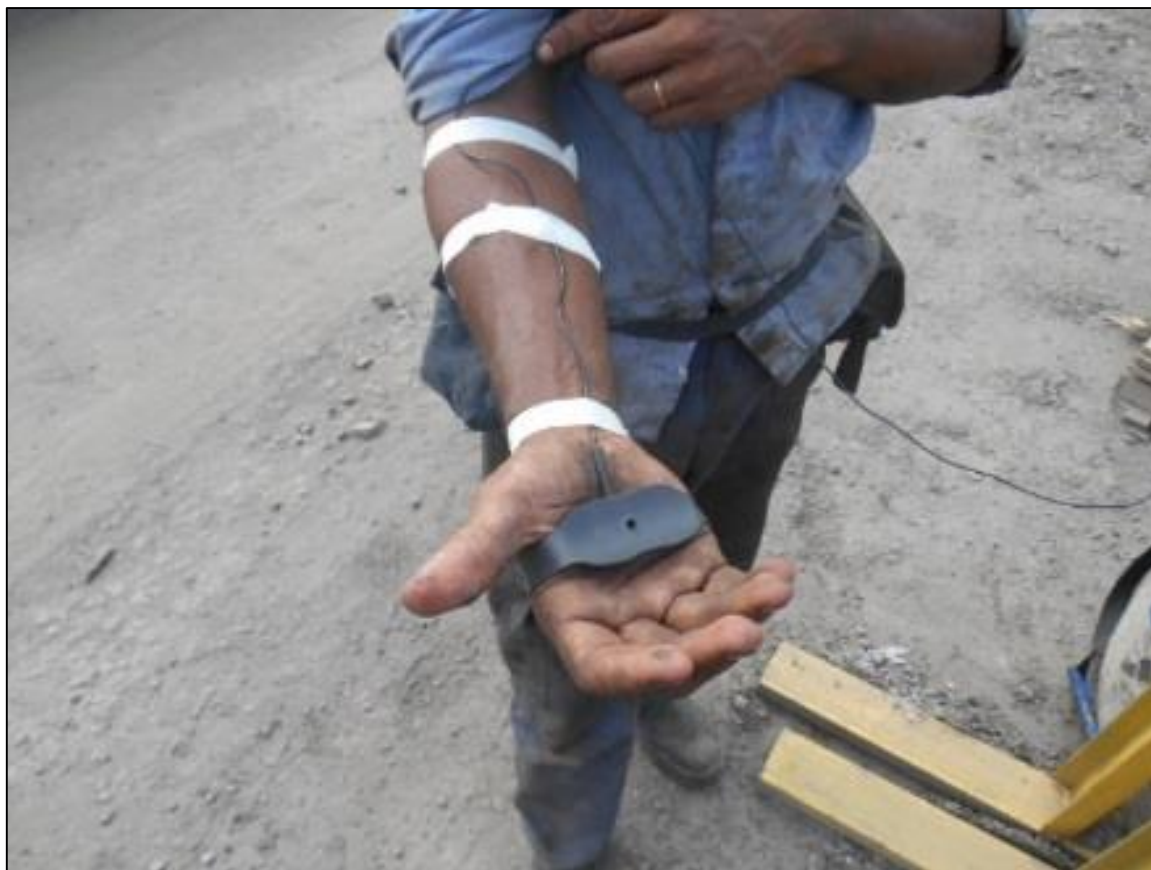
Figura 14 - Posicionamento do acelerômetro na palma da mão antes de iniciar a avaliação
