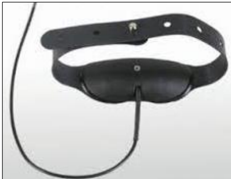
Figura 11 - Acelerometro triaxial, adaptador para mãos SV 105 da Marca Svantek
